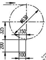
NP型清扫器安装孔尺寸
